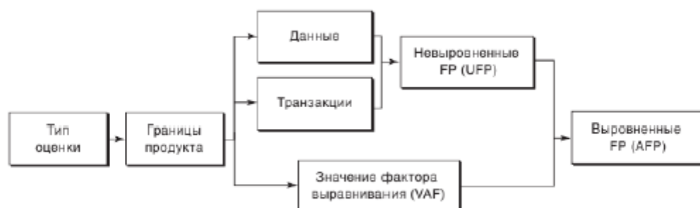
Рис 2. Процедура оценки функционального размера по методу FP.
