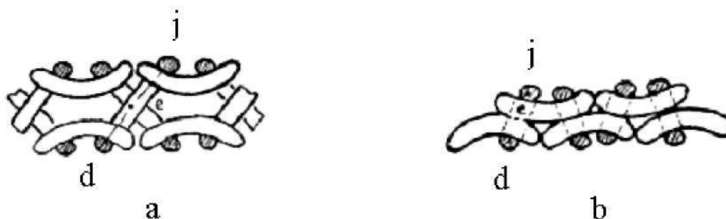
6.6 -rasm. Interlok va lastik to'qimalarining ko'ndalang kesimlari
