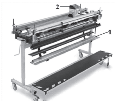
5.10-rasm. Bog'lash mashinasi va aravachasining ko'rinishi va ip ulash jarayoni.
