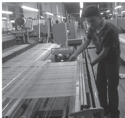
5.10-rasm. Bog'lash mashinasi va aravachasining ko'rinishi va ip ulash jarayoni.
