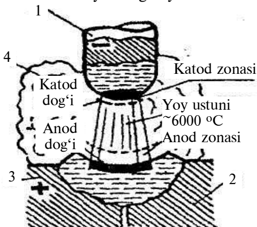
78-rasm. Payvandlash yoyining sxemasi:
