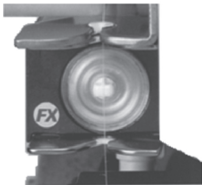
50-rasm. Ip tarangligini rostlovchi «Autotense» tizimi.
