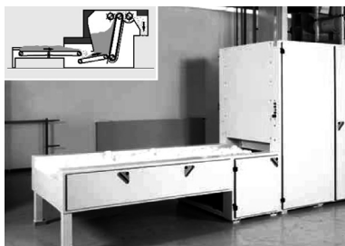
5-rasm. Ta'minlovchi-aralashtiruvchi mashinaning texnologik sxemasi.
