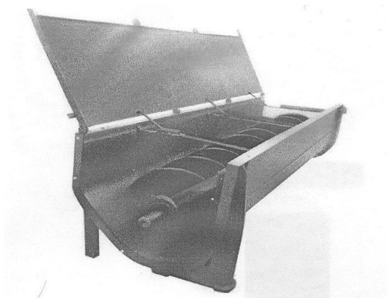
4.1-rasm. VR-2 turidagi vintli konveyerning umumiy ko‘rinishi.
