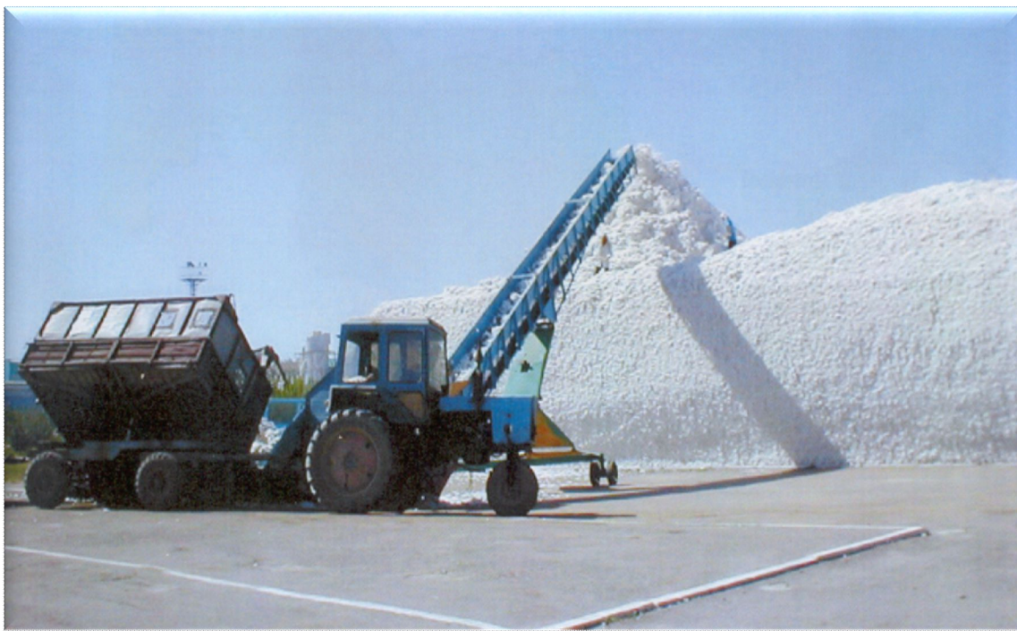
3.2-rasmda. Paxtani ochiq maydonchaga ochiq g'aram qilib joylashtirish ishlarini amalga oshirilayotgan jarayonning umumiy ko'rinishi.
