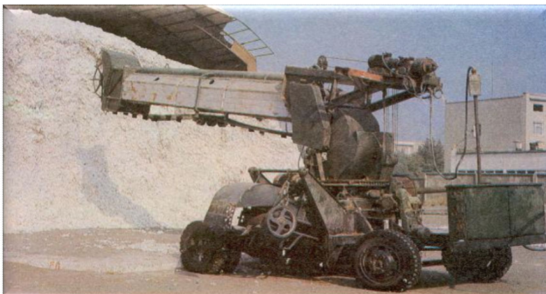
9.5-rasm. RP- rusumli buzgich-ta'minlagichning lentali konveyer bilan birga umumiy ko'rinishi.
