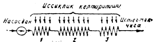
13.6 -расм. Тўғри оқимли қозоннинг бир ўрамли трубалардан иш жисмининг ҳаракатланиши схемаси.
