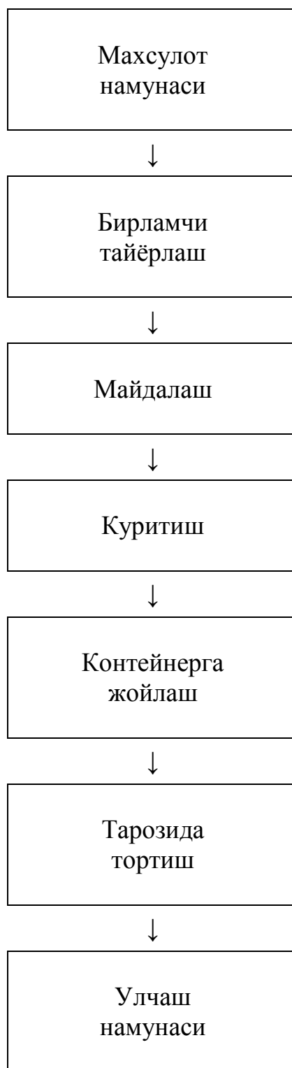
17–расм. Курилиш материалларидан улчаш намуналарини тайёрлаш схемаси
