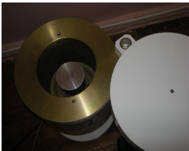
14–расм. Химоя камераси ичига жойлаштирилган сцинтилляторли БДБГ блоки (чаңда) ва қуритиш шкафи (унгда)
