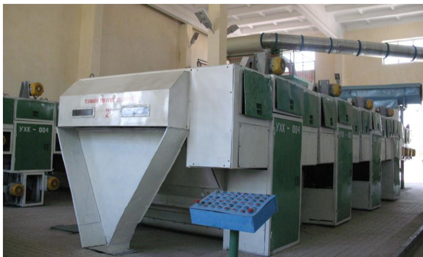
5.5-rasm. 1XK rusumli chigitli paxtadan mayda iflosliklarni tozalash mashinasining umumiy ko'rinishi.
