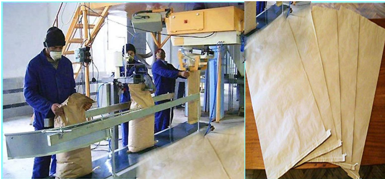
3.4-rasm. Tayyor urug'lik chigitlarni qog'oz qoplarga qoplash jarayoni
