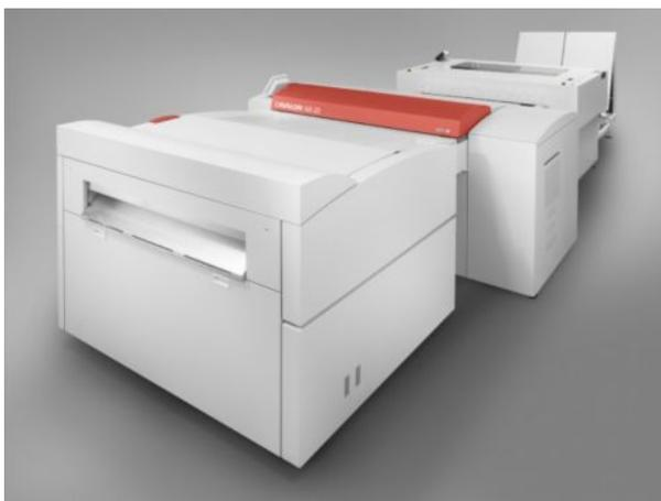
Avalon N8 — СТР-устройство высшего класса для экспонирования термальных пластин от формата 450 x 370 мм до 1160 x 940 мм. Технология экспонирования — внешний барабан с вакуумным прижимом с ИК-лазером 830 нм. Разрешение от 1200 до 4000 dpi.
