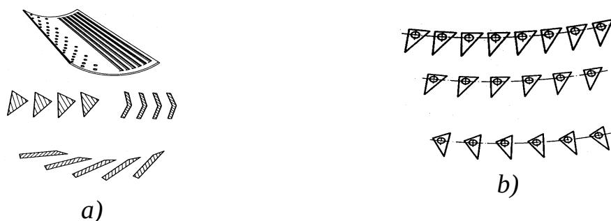
10-rasm. Kolosniklar a), ularning oʻrnatilishi b).
