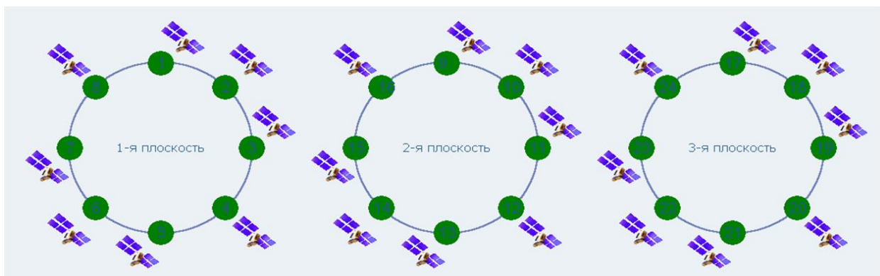
Рис. 1.3. Конфигурация орбит спутников навигационной системы ГЛОНАСС
