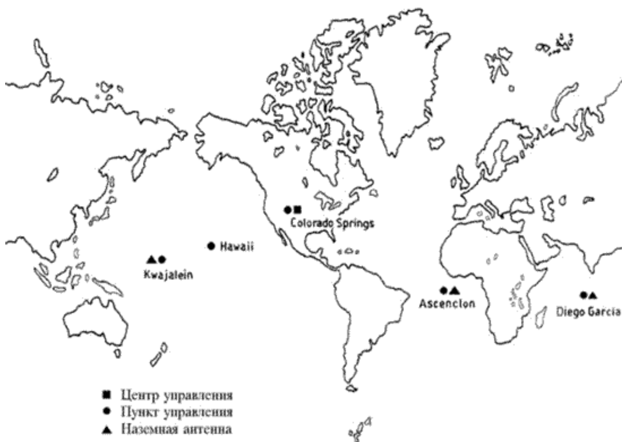
Рис. 1.6. Сегмент наземного комплекса управления системы GPS
