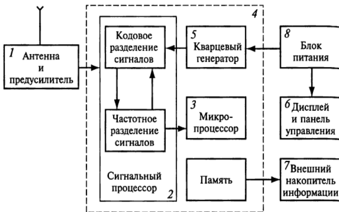
Рис. 2.1. Структурная схема приемника: 1 — антенна с предусилителем; 2 — идентификатор сигналов и распределение частот по каналам; 3 — микропроцессор для управления работой приемника; 4 — расшифровка принятой информации, вычисление абсолютных координат и поправок в часы приемника, выполнение фазовых измерений; 5 — стабильный кварцевый генератор; 6 — дисплей и панель управления; 7 — блок памяти для записи и хранения информации; 8 — блок питания
