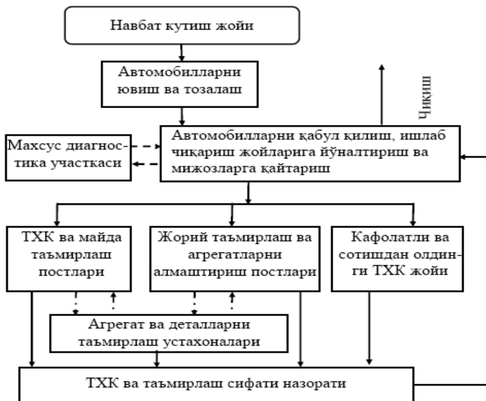
4.1-рasm. АСКларида автосервисни ташкил қилишнинг технологик жараёни.
