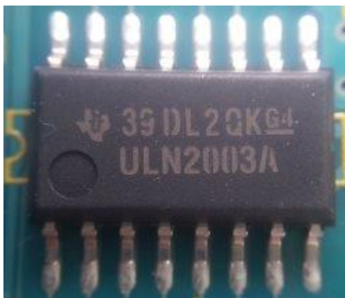
Рисунок 2.27. Корпус ULN2003A: SOP-18
