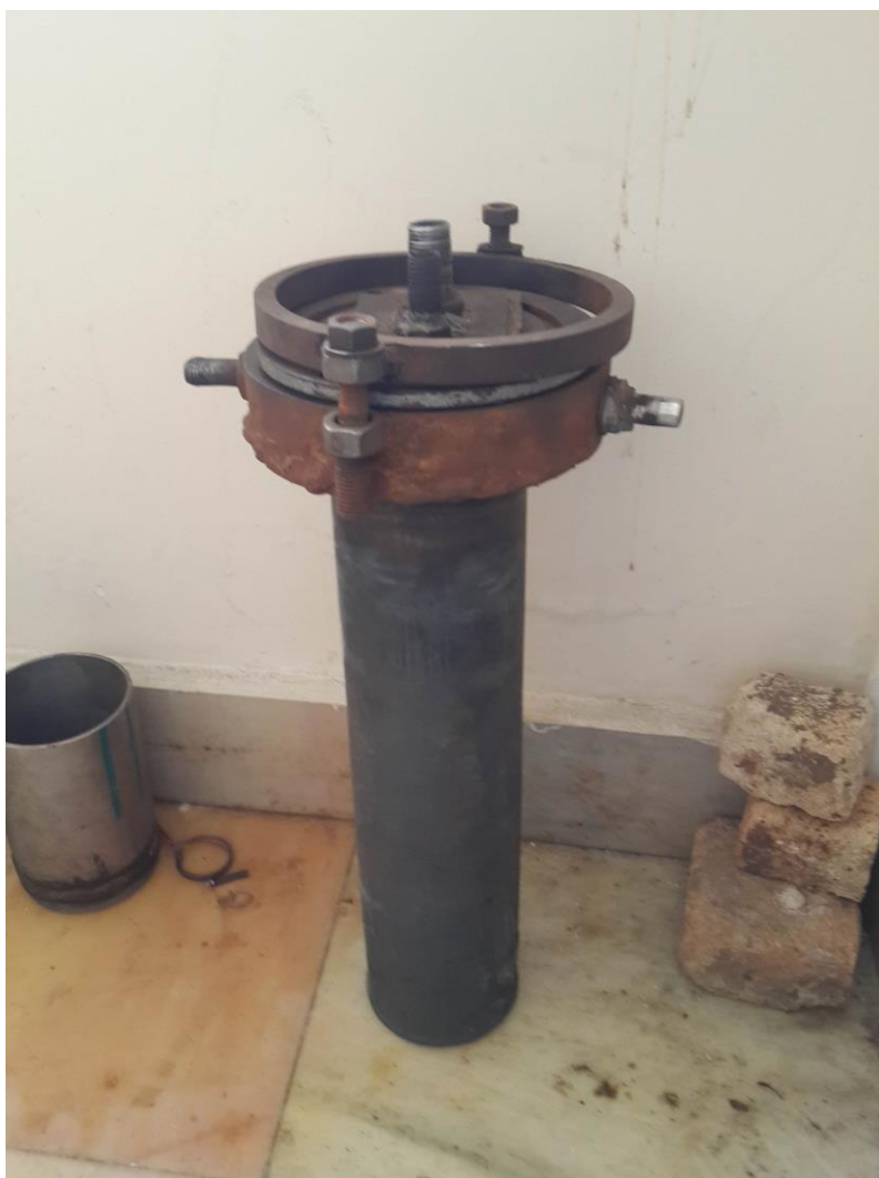
3.1-rasm. Maxsus havosi so'rib olinishga mo'ljallangan silindirik qism.
