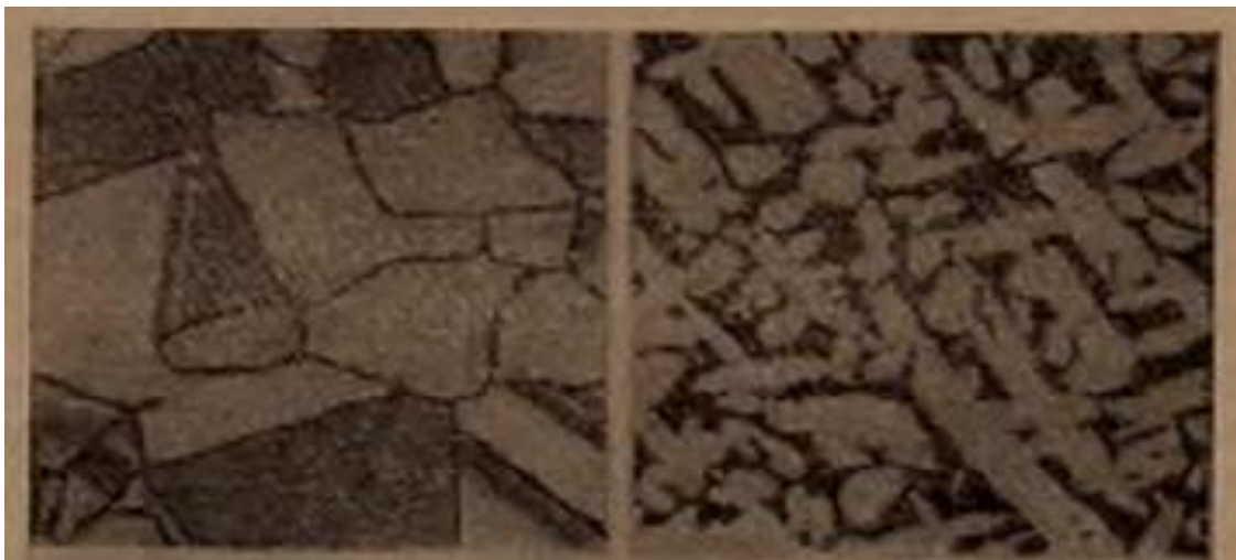
2.4–rasm. Mis va ruxning amalda ishlatiladigan qotishmalarning mikroskopik tuzilishi: chapda-tarkibida 39 % gacha rux bo'lgan latun ( \alpha -latun) (x200); o'ngda-tarkibida 39-45% gacha rux bo'lgan latun ( \alpha + \beta' ) latun (x500).
