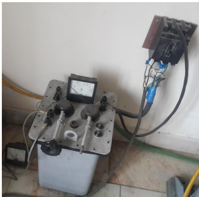
3.6-rasm. Tok kuchini nazorat qilib haroratni boshqaruvchi qurilma
