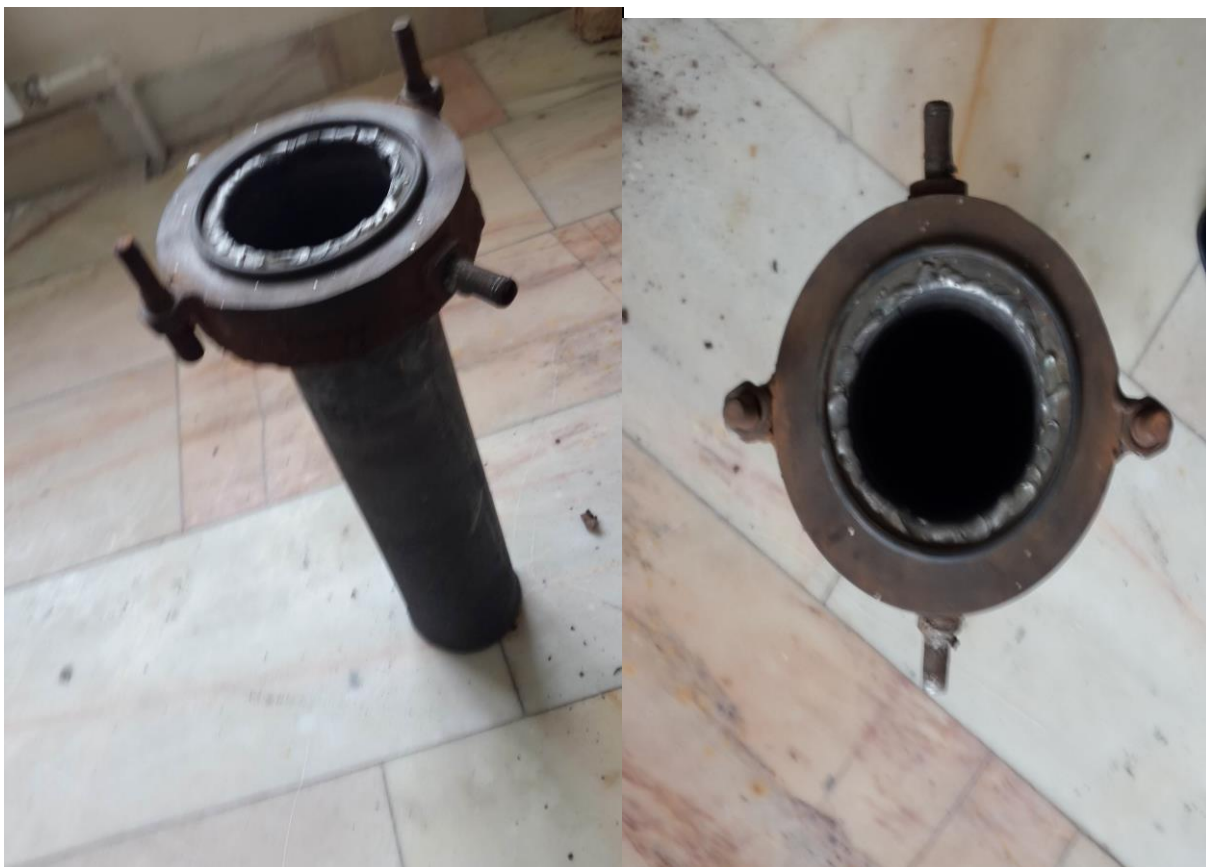
3.2-rasm. Vakuum hosil qilinadigan yoki himoya gazi toldiriladigan bo'shliq qism.
