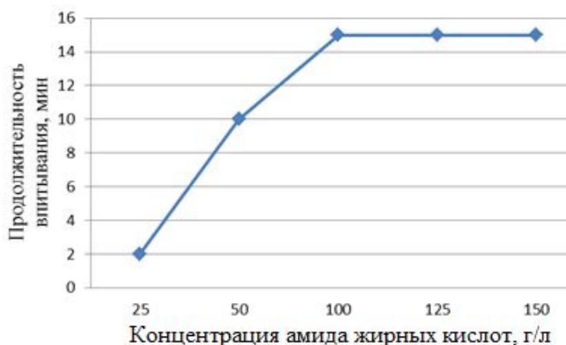
**Рис.3.21 - Зависимость продолжительности впитывания воды от концентрации препарата АЖК.**
