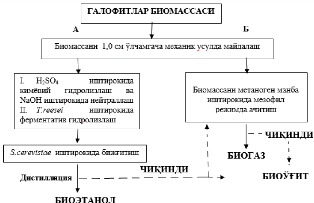
6-расм. Галофитлар биомассасидан биоёқилғилар ажратиб олиш чизмаси
