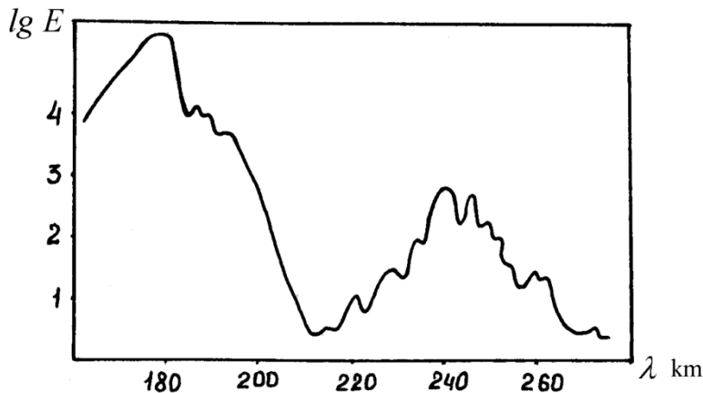
4 – rasm. Benzolning geptandagi UB – spektri.
