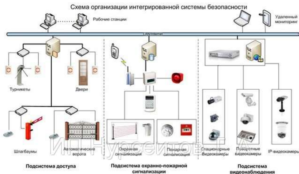
1.1. rasm. – xavfsizlikning integratsiyalangan tizimining tuzilish sxemasi.
