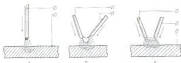
4-rasm. Payvandlashda elektrodni tok manbaiga ulash chizmasi: a - bevosita yoy ta'sirida; b - bilvosita yoy ta'sirida; v - har ikkisinin ta'sirida.
