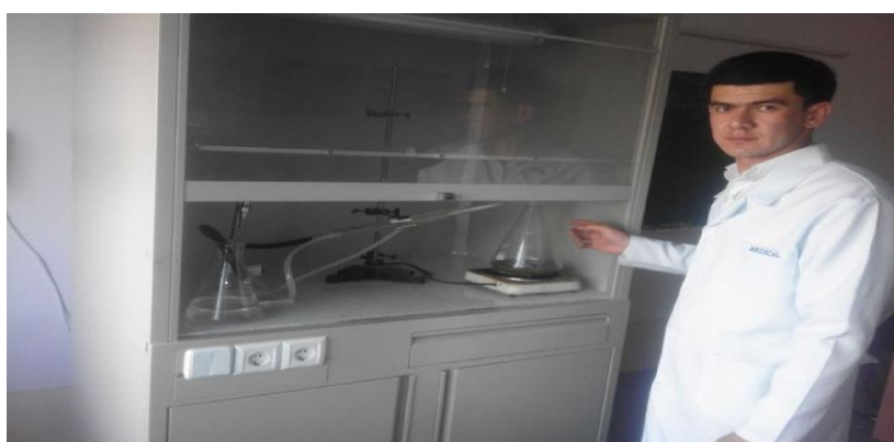
Ekstraksiya qilingan archa o'simligi tarkibidagi efir moylarini haydash jarayoni
