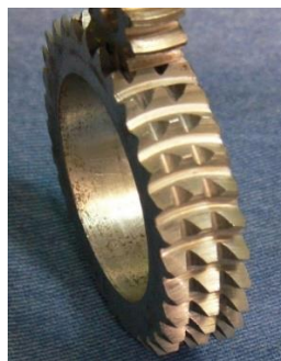
Рис.2. Типовая конструкция обкатного-шевера
