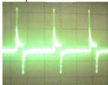
Рис.1. Осциллограмма тока при переключении диода на основе 4H-SiC<B>. масштаб по току (вертикаль) – 0,05 А/дел, по времени (горизонталь) – 10 нс/дел.
