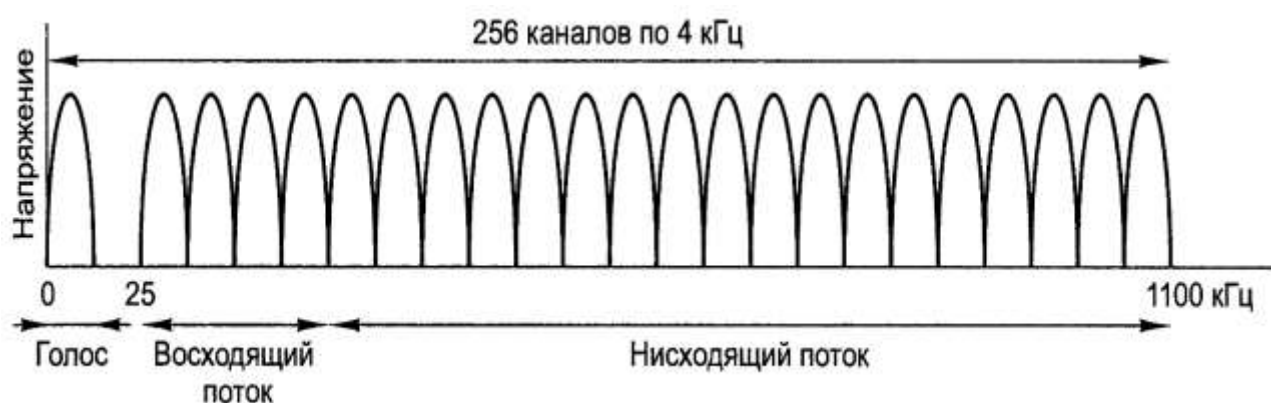
1.65-súwret. ADSL-modem járdeminde xızmet kórsetiw sizilması
