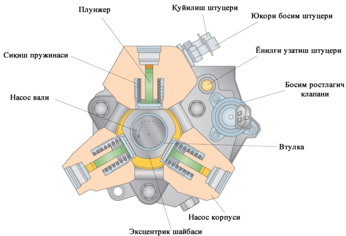
27-расм. Юқори босим насоси тузилиши
