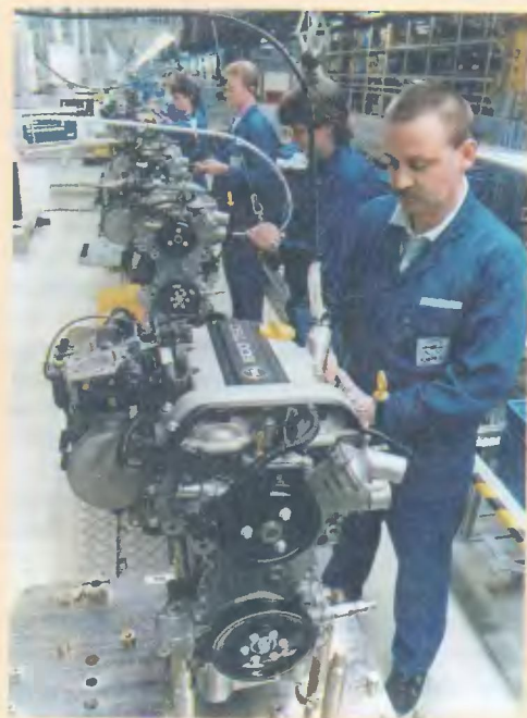
Окончательная сборка трёхцилиндровых двигателей на австрийском филиале фирмы «Опель».
