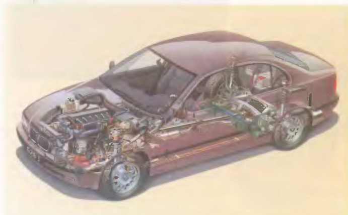
Классическая компоновка BMW. Германия.
