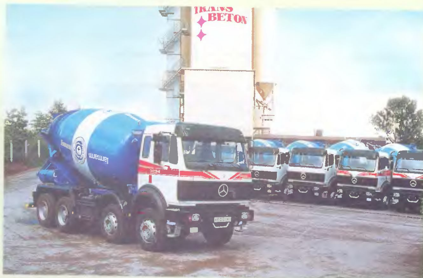
▲ Бетономешалки «Штеттер» на базе четырёхосных (колёсная формула 8 × 4) грузовиков «Мерседес-Бенц-SK3234». Германия.
