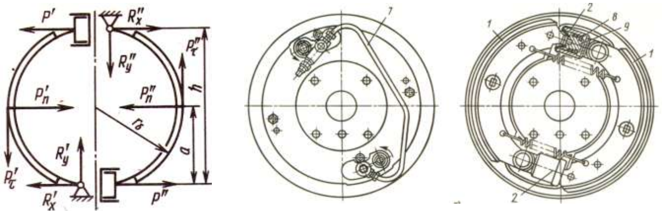
10.6-расм. Юритма кучлари тенг ва таянчлари икки тарафга жойлашган тормоз механизмнинг схемаси ва конструкцияси
