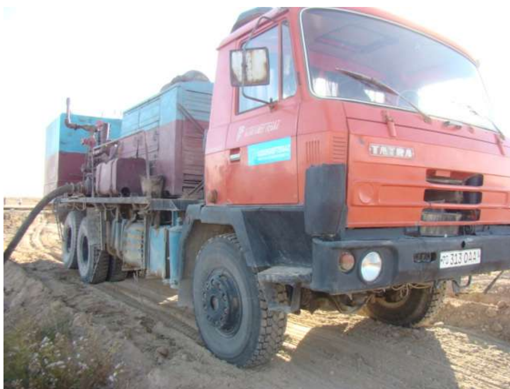
Расм 2.3. ТАТРА-815нинг АСФ-700 махсус қурилмаси билан газли скважинада ишлаши
