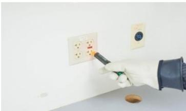
**Non-contact voltage detector-[nɒn'kɒntæ di'tektə] индикатор напряжения, kuchlanish aniqlovchi**
