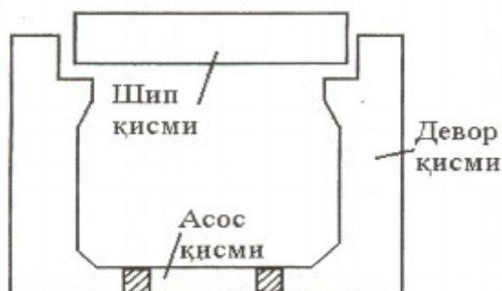
22 расм. Заводларда тайёрланадиган йирик темирбетон қисмлардан йиғиладиган бир изли темир йўл тоннелининг конструкцияси
