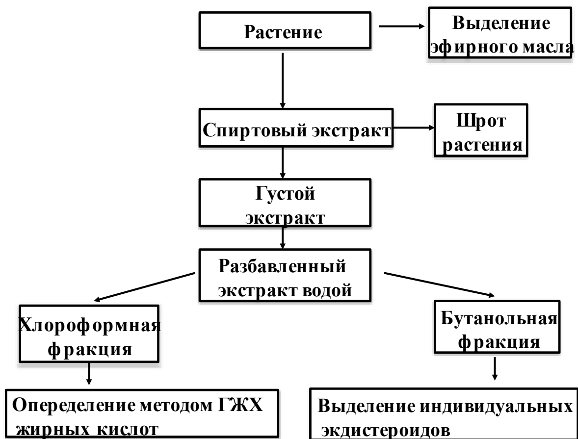
Рис. 1. Схема выделения экистероидов из надземной части растений рода Silene
