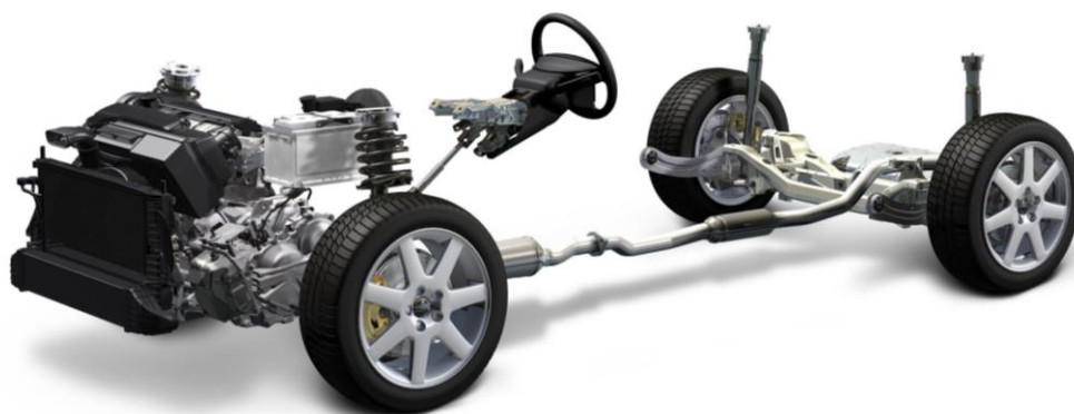
Орқа етакчи автомобилнинг трансмиссияси кўриниши
