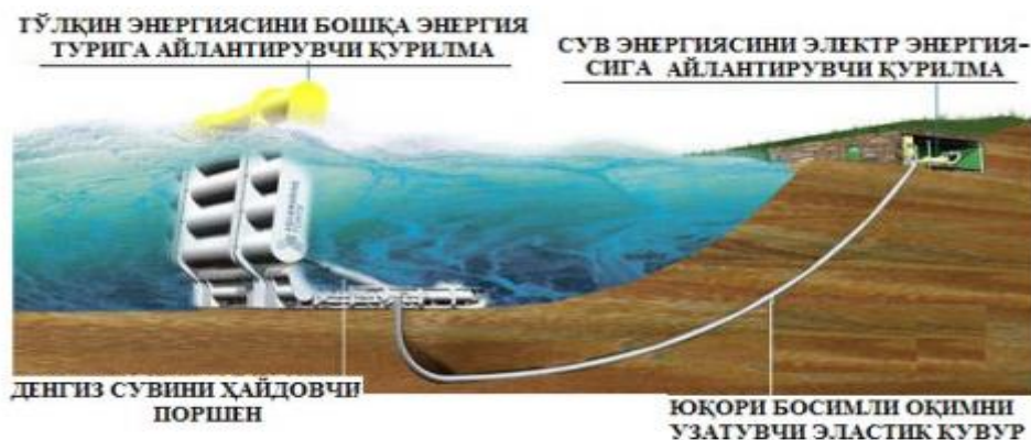
16.3-rasm. To'liqindan foydalanib elektroenergiya ishlab chiqaruvchi
