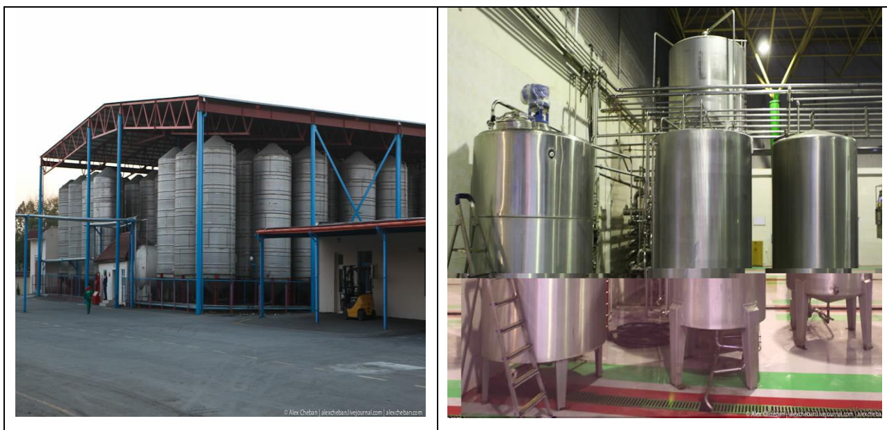
2.5-расм. Анор шарбатини йиғивчи ва чўктириш қурилмаси.
