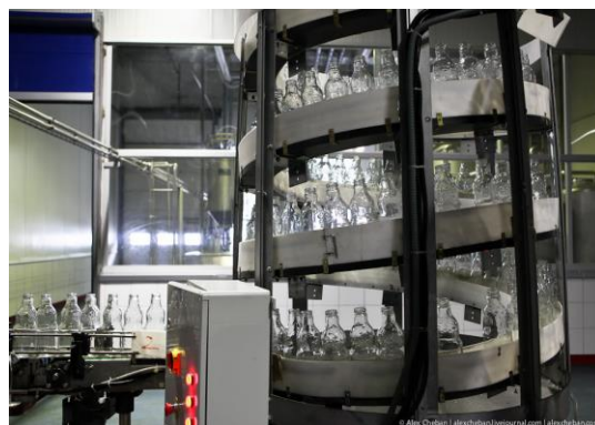
2.9-расм. Анор шарбатини бутилкаларга қуйиш жараёни.
