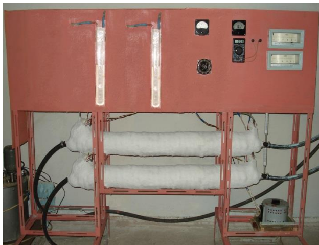
2.3-rasm. Quvurlarda turbulizatorlar qo'llanilganda gidrodinamik va issiqlik almashinish jarayonlarini tadqiqot qilish uchun tajriba qurilmasining umumiy ko'rinishi.
