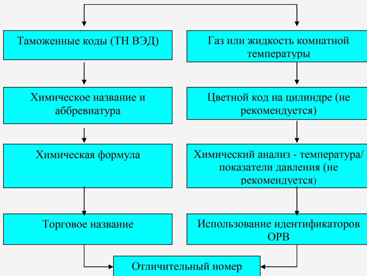
Рис. 8.1. Методы определения озоноразрушающих веществ (ОРВ)
