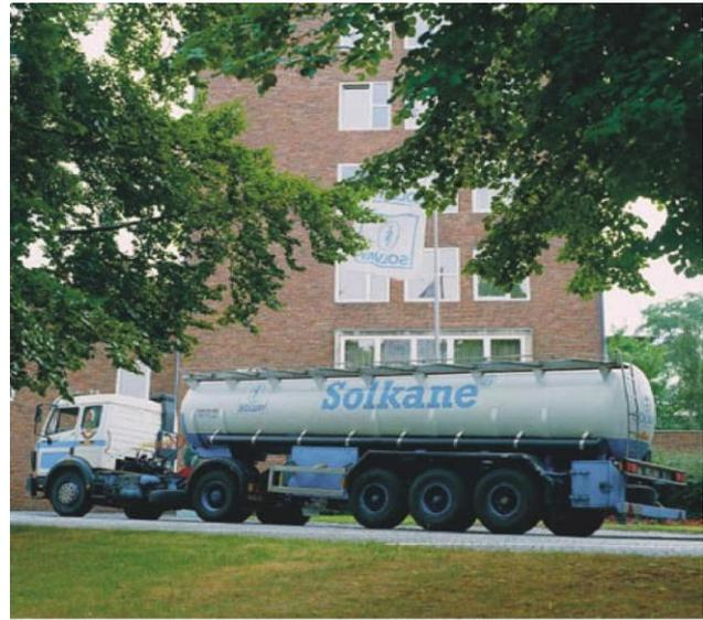
**Рис. 8.7. Грузовые цистерны, используемые для транспортировки и хранения жидких ОРВ, например ГХФУ-141-б**
