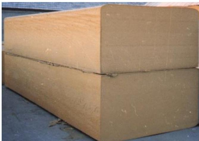
**Рис.8.11. Пенки, в отдельных твердых пенах и пенообразных товарах, например изоляционные трубы, сэндвич-панели, двери (СFC-11, НСFC-141b, НСFC-142b)**
