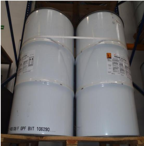
**Рис.8.6. Другие виды многоразовых герметизированных цилиндров для транспортировки и хранения газов ОРВ**
