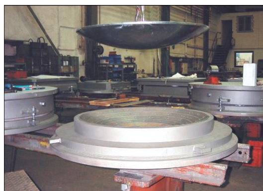
21-расм. Францияни А75 автострадасидаги Millau виадукининг шарли сейсмоизоляцияловчи таянч қисмлари
