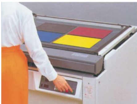
34.1-rasm. Analogli svetoproba: rangi ranglarga ajratilgan rasimga mos keladigan varaqlar oq taglikka aniq o'rnatiladi
