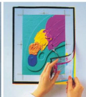
34.1-rasm. Analogli svetoproba: rangi ranglarga ajratilgan rasimga mos keladigan varaqlar oq taglikka aniq o'rnatiladi
