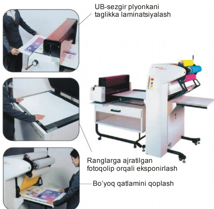
34.3-rasm. Ranglarga ajratilgan fotoqoliplardan olinadigan analogi svetoproba
