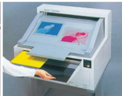
34.1-rasm. Analogli svetoproba: rangi ranglarga ajratilgan rasimga mos keladigan varaqlar oq taglikka aniq o'rnatiladi
