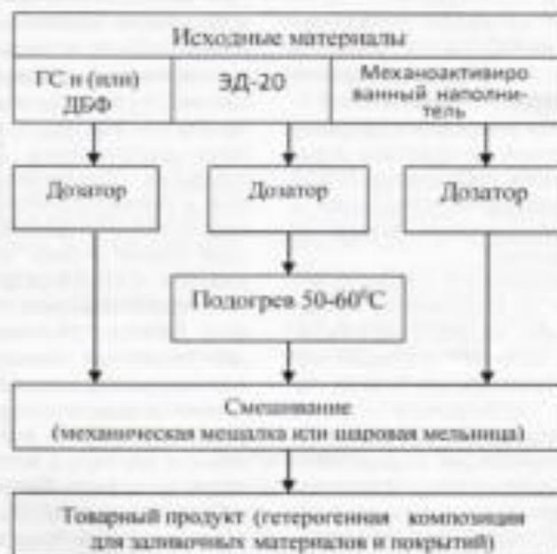
Рис. 1. Технологическая схема получения композиций для заливочных материалов и покрытий.
