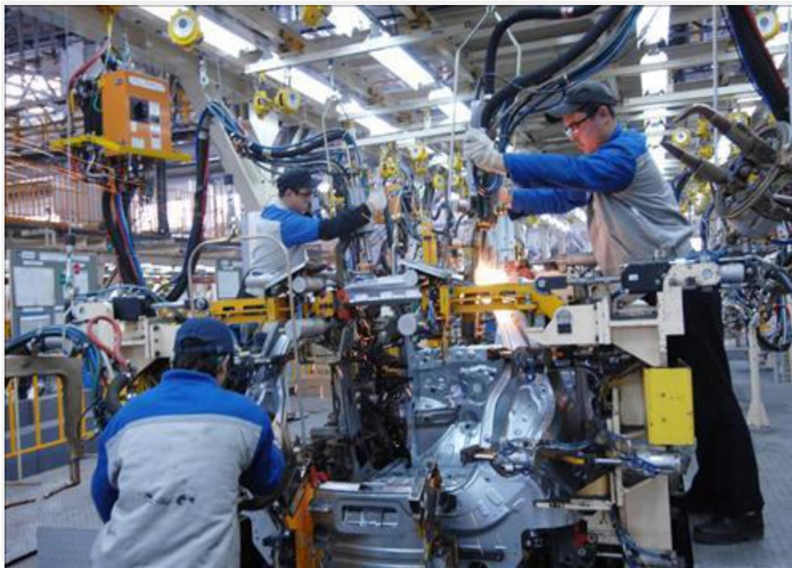
3-rasm: Nuqtali (PSW va MSW) payvandlash qurilmalarida payvandlash jarayoni
