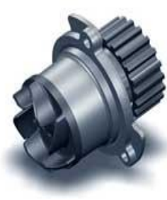
6.6-rasm. Suyuqlik nasosi va ventilyator: 1-ventilyator shkivining gubchagi; 2-ventilyator; 3-shkiv; 4-nasos korpusi; 5-parrak korpusi; 6-parrak; 7-siquvchi salnik.
