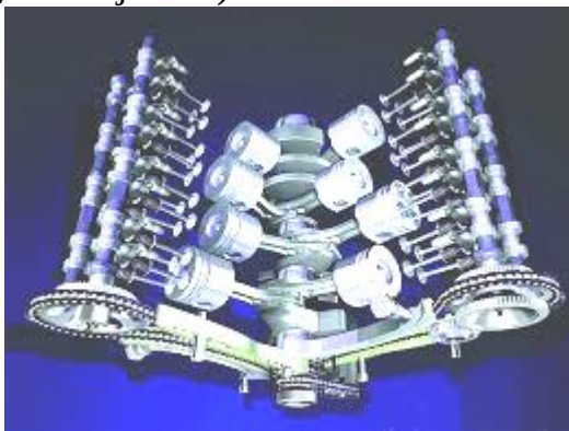
3.6-rasm. To'rt taktili sakkiz silindrli V – simon dvigatel krivoship-shatunli mexanizmning sxemasi.
