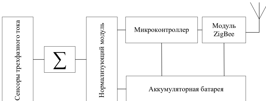
Рис. 4. Структура IoT-сенсора, обеспечивающий дистанционный контроль одно-, двух- и трехфазных токов
