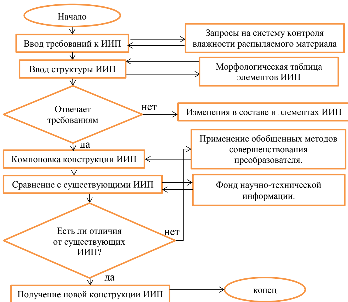
Рис. 5. Структурная схема алгоритма расчета оптимального состава модернизационного измерителя тепловлажностных свойств мелкозернистых материалов.
