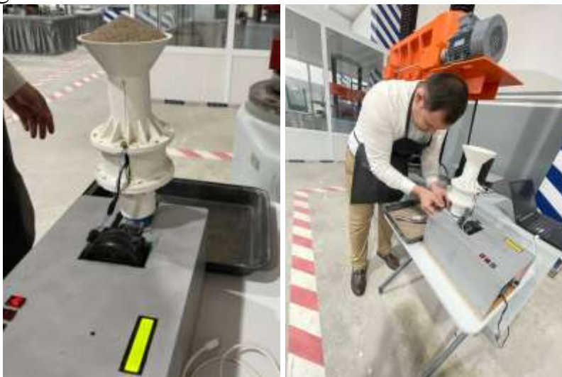
6-rasm. Mayda donador sochiluvchan materiallarning issiqlik namlik parametrlarining takomillashtirilgan o‘lchash qurilmasining tajribaviy namunasi.
