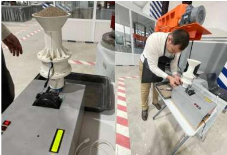
Рис. 6. Экспериментальный образец модернизированного устройства измерения тепловлажностных параметров мелкозернистых сыпучих материалов.
