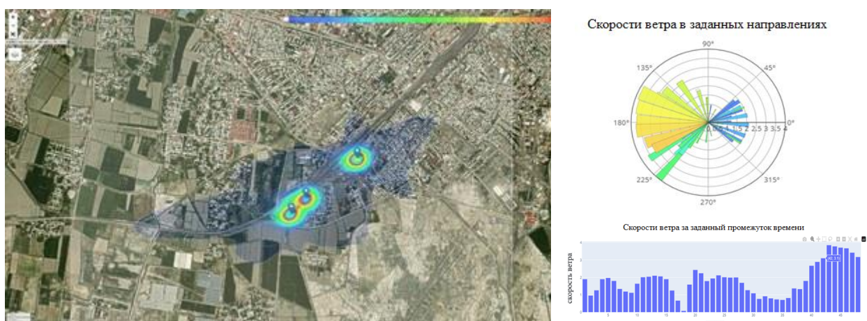
Рис. 4. Динамика переноса и диффузии аэрозольных частиц в атмосфере при три источника Q_1=800 \text{ мг/м}^3\text{с} ; Q_2 =1000 \text{ мг/м}^3\text{с} ; Q_3 =900 \text{ мг/м}^3\text{с} ; t=48 \text{ ч} .
