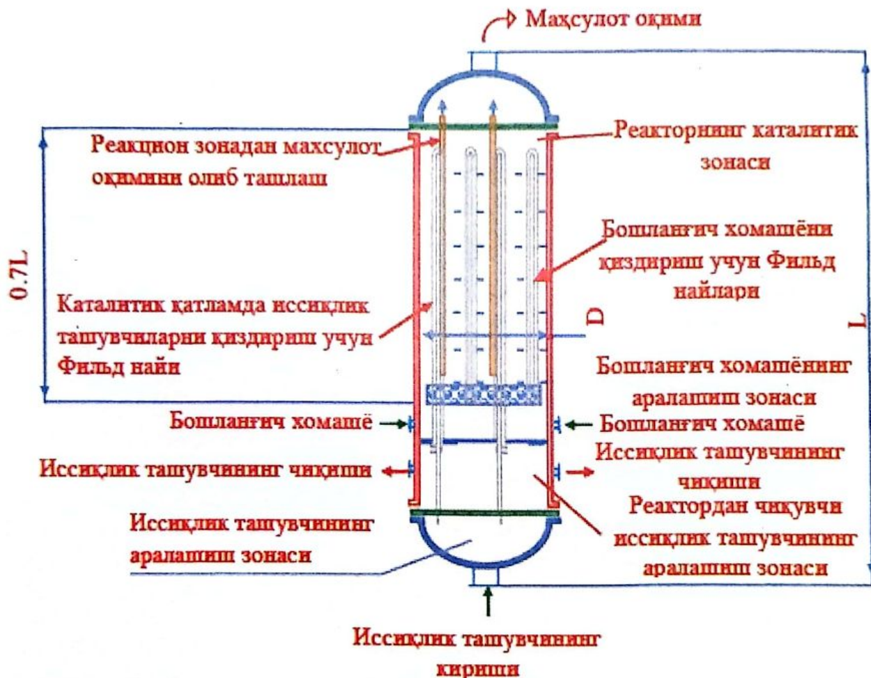
10-расм. Метанол ва диметилэфирдан тўйинмаган этилен катори углеводородлар олиш учун мўлжалланган реактор
