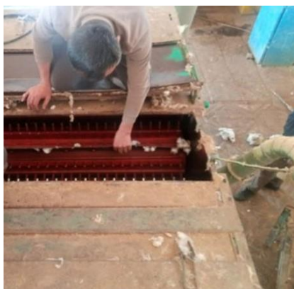
25- rasm. 1XK uskunasiga konstruksiyon o‘zgartirish kiritib takomillashtirilgan qoziqchali barabanni o‘rnatish jarayonining ko‘rinishi.
