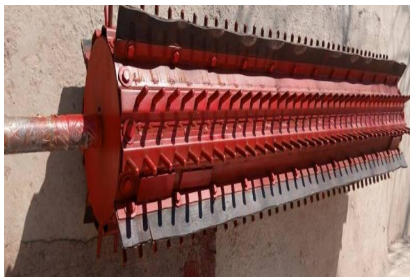
17- rasm. Rezinali parrakka ega bo'lgan qoziqli barabanni tajriba nusxasi
