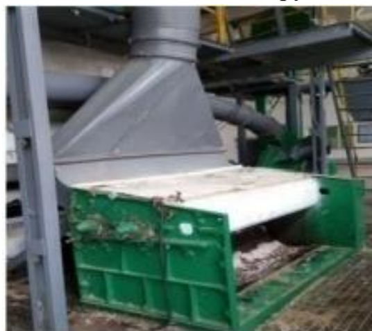
Рис. 26. Общий вид модернизированного двухбарабанного волоконоочистителя марки 2ВПМ
