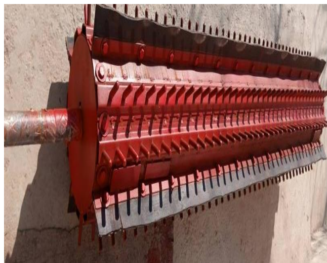
Рис.17. Экспериментальный образец колкового барабана с резиновыми лопастями
