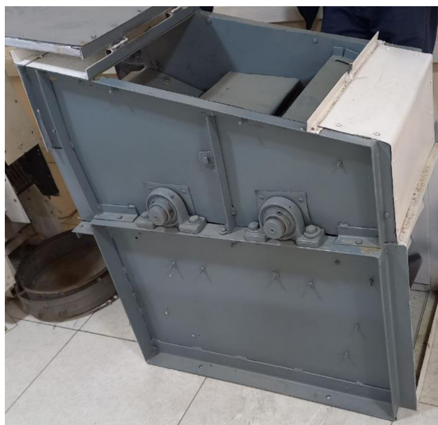
24- rasm. Ikki barabanli takomillashtirilgan tola tozalagichni laboratoriya ko'rinishi
