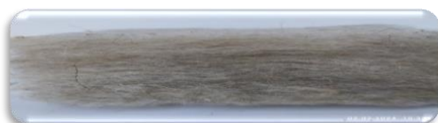
Образец № 3. Содержание полиэфирного волокна в войлоке 30%, толщина – 4,5 мм
