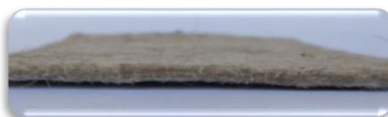
Образец № 2. Содержание полиэфирного волокна в войлоке 20%, толщина – 3,2 мм
