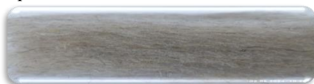
Образец № 1. Содержание полиэфирного волокна в войлоке 10%, толщина – 2,9 мм
