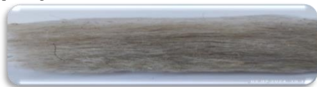
3-namunadagi kigiz tarkibi va geometrik parametrlari: poliestertolasi - 30%, qalinligi - 4,5 mm.
