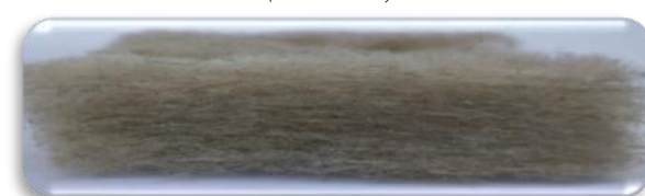
Образец № 4. Содержание полиэфирного волокна в войлоке 40%, толщина – 6,5 мм
