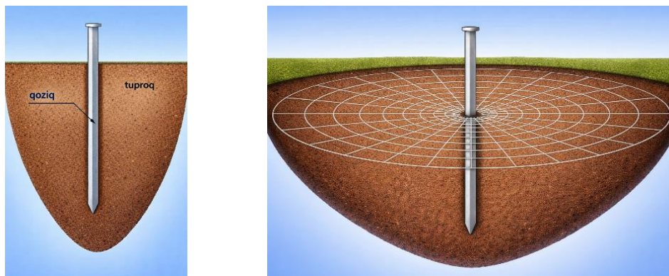
2-rasm. Integrallashgan qoziq–tuproq tizimi va unga mos chegaraviy elementlar modeli.
