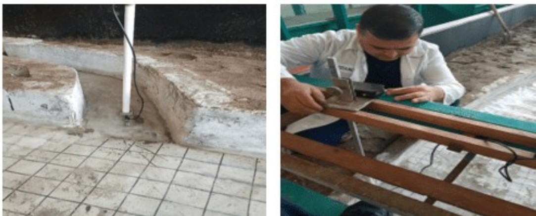
6-rasm. Eksperimental tadqiqot o'tkazish jarayonidagi oqimning o'rtacha tezligini hisoblash.
