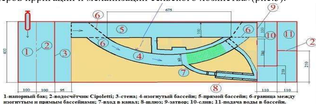
Рис. 5. Модель бесплотинного водозабора, в которой проводилось экспериментальное исследование.
